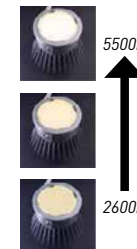
Revêtements composites luminescents sous excitation UV (395 nm)
